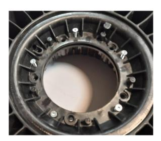
4) Den Reifen umdrehen und in die große Felge 5 Schrauben einsetzen und festziehen.
