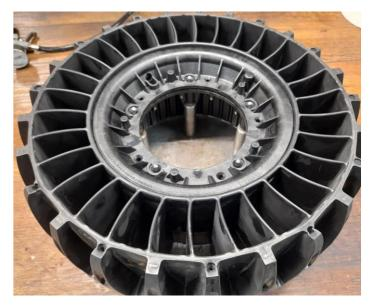
3) 5 Schrauben in die kleine Felge einsetzen und festziehen (Kunststoffschraube 5x20 Torx). Grundsätzlich Kreuz festziehen.
